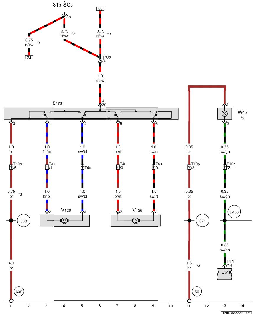
驾驶员座椅腰部支撑纵向调节电机, 驾驶员座椅腰部支撑高度调节电机,
