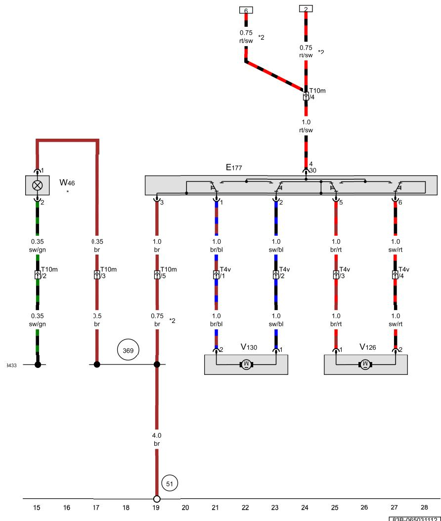
副驾驶员座椅腰部支撑纵向调节电机, 副驾驶员座椅腰部支撑高度调节电机, 右后脚部空间照明灯
